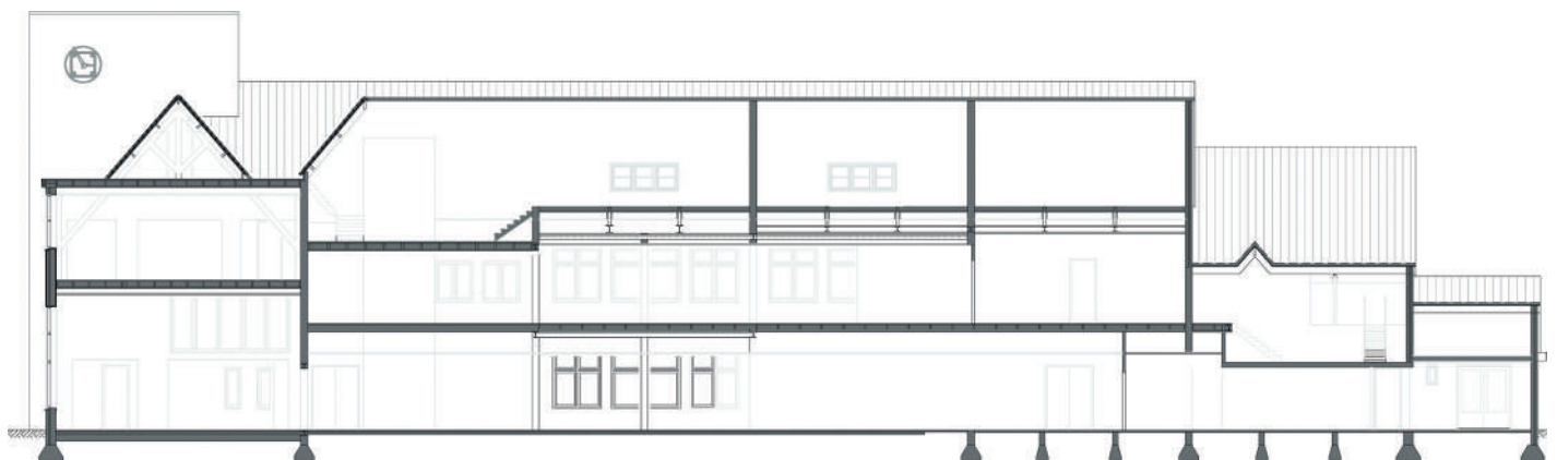
▲ De oude situatie, met de hoge gymnastiekzaal en, onder het trappetje naar de zolder, de hoge klaslokalen.
